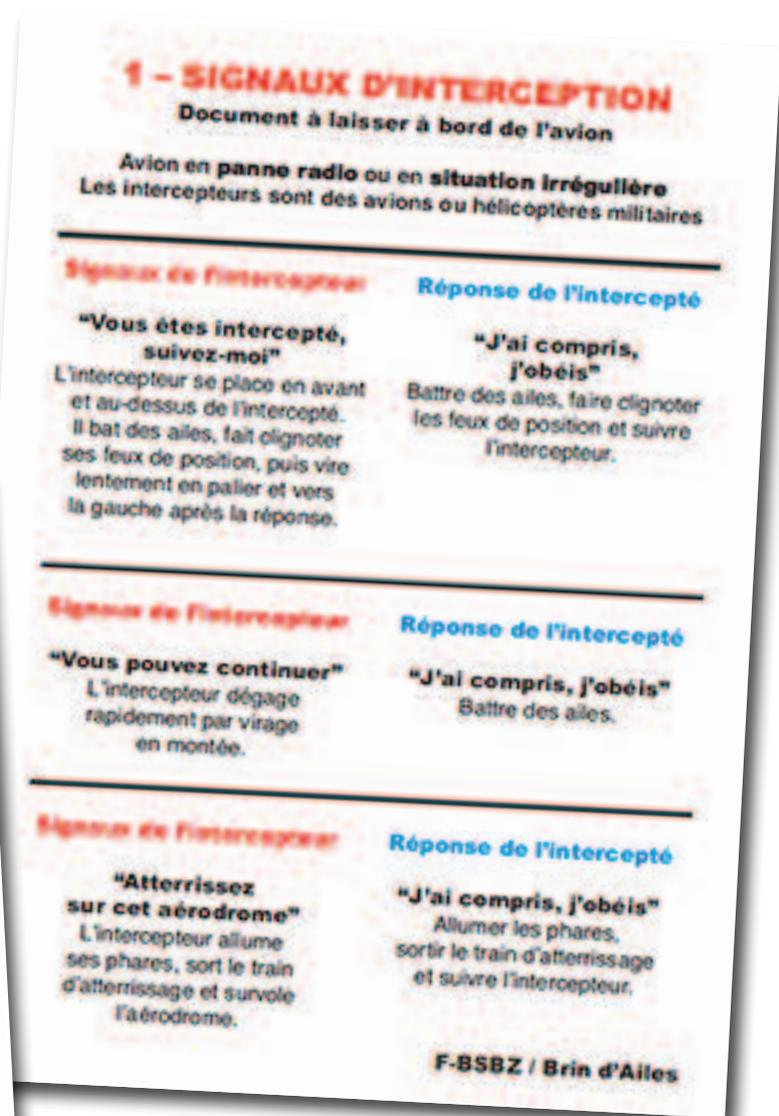
Une fiche figure dans la poche avant du cockpit du F-BSBZ, rappelant les signaux conventionnels en cas d'interception, avec les manoeuvres de l'aéronef intercepteur et les réponses possibles de l'aéronef intercepté.
